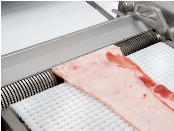
Die Band-Entschwartzmaschine BXA eignet sich zum vollautomatischen Entschwarten von flachen Teilstücken wie Bauch und Rückenspeck.
