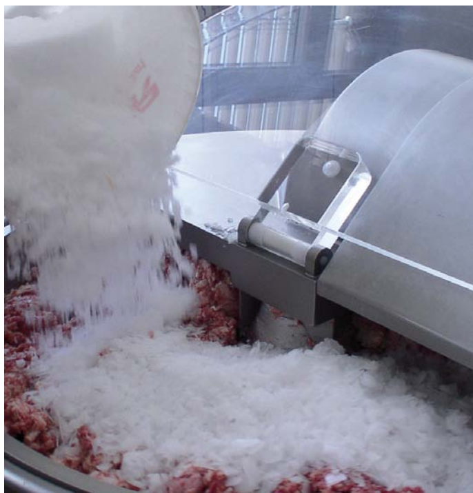
MAJA-Scherbeneiserzeuger liefern vollautomatisch und auf Knopfdruck genau die Eisqualität, die sich beim Kuttervorgang ideal mit dem Brät vermischt.
