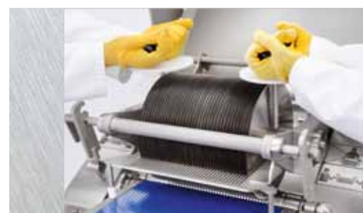
Ausbau der Schneidwalze
