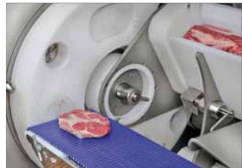
Rotierendes Kammersystem erlaubt kontinuierliche Beschickung.
