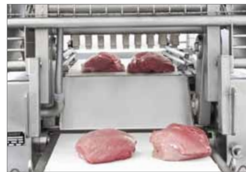
Vollautomatisches Entvliesen runder Teilstücke mit der MAJA SR 500 A
